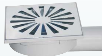
CHABS 15 M CHIUSINO SIFONATO IN ABS CROMATO CON SCARICO ORIZZONTALE ORIENTABILE
